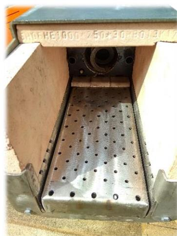
Отсутствие спекания продуктов горения (коржей) реализовано за счет движущегося колосника с многоточечным методом подачи воздуха в зону горения, и также возможностью установки легко заменяемой мешалки топлива, которая не дает формироваться коржам золы, спекаемых при сжигании низкокачественного топлива в процессе работы. Не требуется дополнительной механической очистки внутри колосника со стороны пользователя. Это делает наши горелки действительно уникальными.
